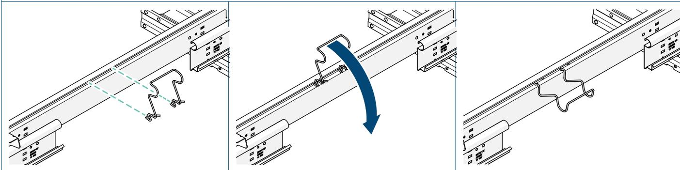
**4** Erweitern Sie das Segment, indem Sie eine weitere Einheit mit der vorinstallierten Kupplung anbringen.
