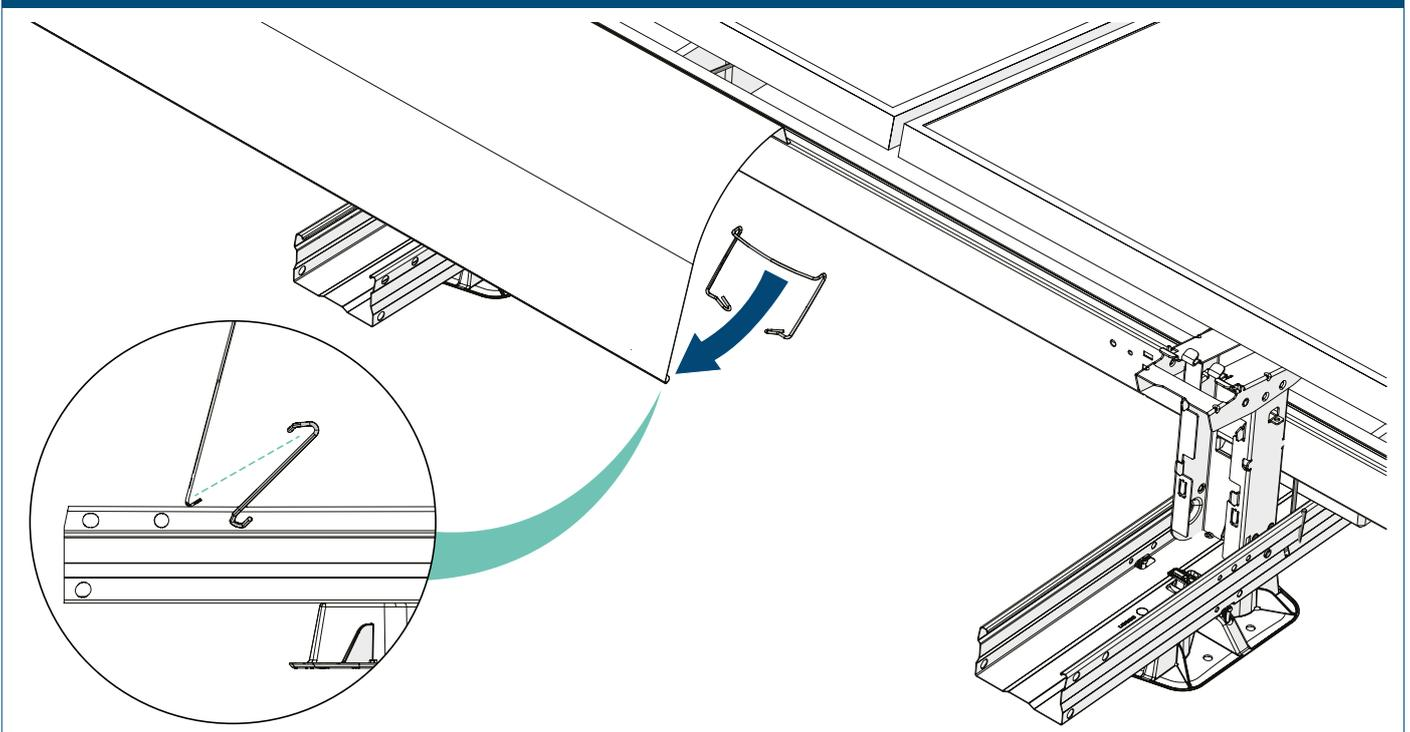
6 Schieben Sie den hinteren Winddeflektor-Clip über die Kante, bis der hintere Winddeflektor-Clip auf der Einheit aufliegt.
