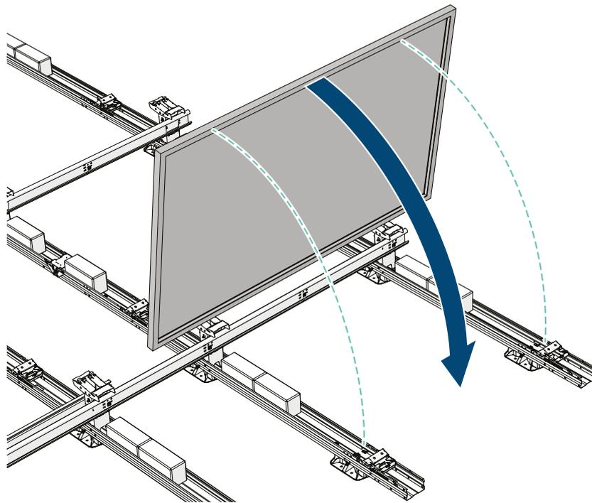
**3** Ziehen Sie das Solarmodul zu sich hin, sodass der Modulrahmen in die hohen Basiselemente einrastet.
