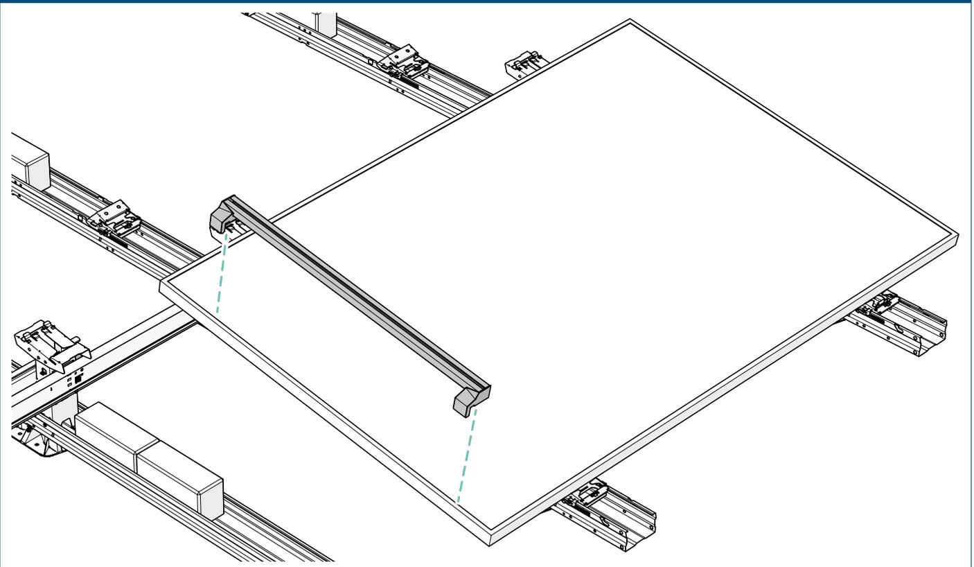
2 Platzieren Sie das Solarmodul aufrecht auf zwei hohen Basiselementen und richten Sie das Solarmodul mittig aus.
