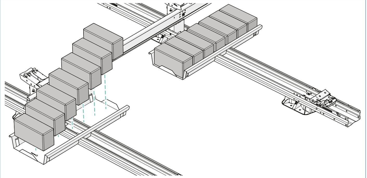
**3** Wenn mehr als eine Ballastablage im Projektplan vorgesehen sind, schieben Sie die äußere Ballastablage gegen die Laschen in der Einheit. In dieser Anordnung können Sie maximal drei Ballastablagen in einer Reihe platzieren.
