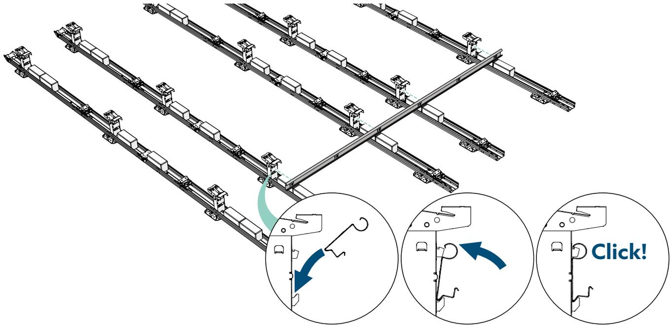
2 Befestigen Sie die anderen Stabilisatoren so, dass jeder Stabilisator den vorhergehenden Stabilisator über zwei hohe Basiselemente überlappt.
