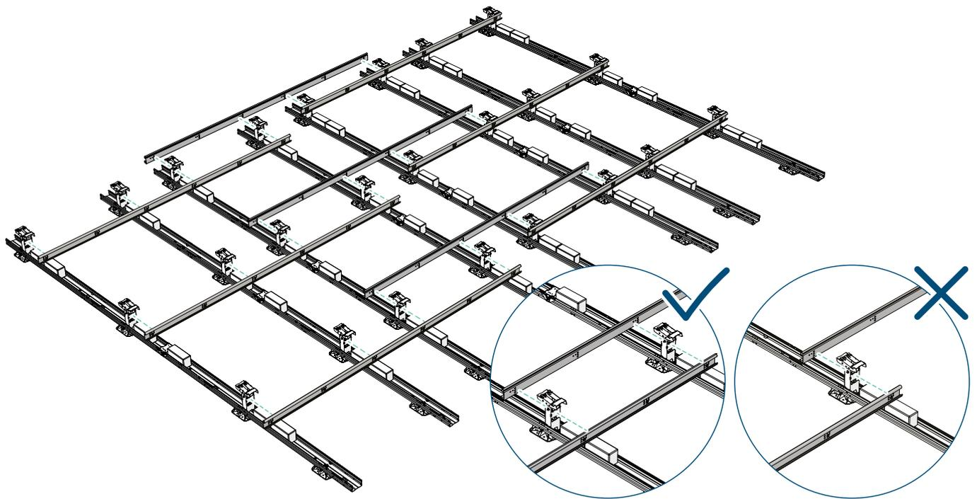
**3** Installieren Sie Kabelhalterungen an der Rückseite des hinteren Stabilisators, um den Abstand zwischen zwei Stabilisatoren zu überbrücken.
