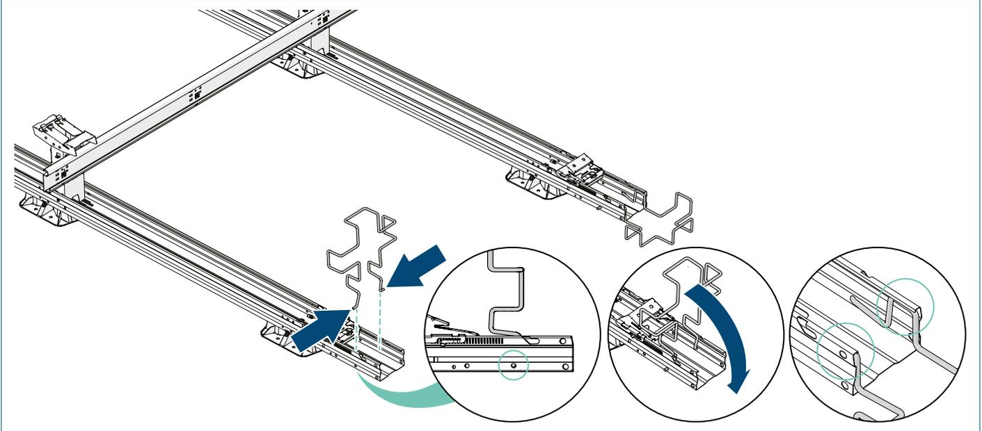
2 Füllen Sie den Perimeter-Ballastbügel immer mit zwei Ziegeln.
