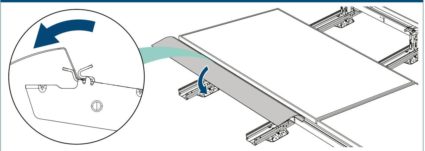
5 Hängen Sie einen hinteren Winddeflektor-Clip in den Flansch an der Unterseite des hinteren Winddeflektors ein.
