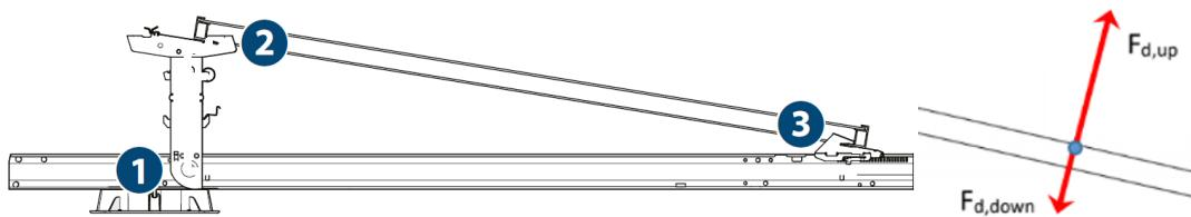
Les composantes horizontales des forces perpendiculaires ( $F$ ) sont utilisées pour la détermination de la résistance au glissement du système.
