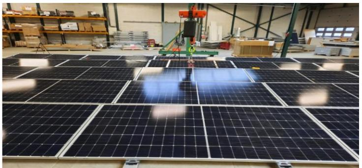
Les mesures de la charge du vent ont été effectuées et élaborées conformément à la recommandation CUR C103 « Études en soufflerie des charges de vent sur les bâtiments (de grande hauteur) » et au projet de norme NEN 7250:2014 «systèmes Énergie solaire - intégration dans les toitures et façades - aspects du bâtiment ».
