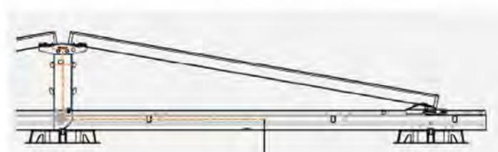
Esdec FlatFix Wave - ballastiertes Montagesystem für Photovoltaik-Module auf
